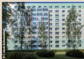
Mit der QP-Serie, eingeführt 1959, wurden erstmals in der DDR raumgroße Elemente verwendet, d. h. die Gebäude sind „Plattenbauten“ aus industrieller Fertigung. Es handelt sich um eine Querwandbauweise mit tragenden Innen- und Außenwänden. Die Giebelseiten wurden zum Teil offen mit Balkonen gebaut.
