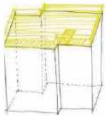
Abbruch Drempel Öffnung Decke Treppenhaus (TH)
