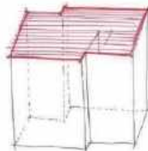
Notdach Bitumen, geschweißt
