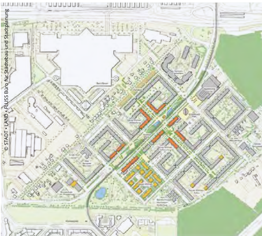
Im Masterplan wurden die zentralen Planungsziele für die ganzheitliche Entwicklung zur Gartenstadt festgeschrieben. Orange – Aufstockung, Gelb – Neubau, Anbau
