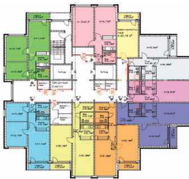
Punkthochhaus: Senioren- und Gemeinschaftsetage mit 8 Wohnungen und Gemeinschaftsraum
