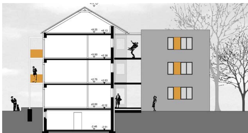
In gelungener Synthese sind neue und alte Gebäudeteile durch Laubengänge funktional miteinander verbunden.
