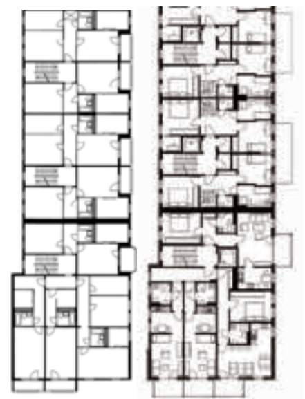
Grundriss 3.OG: vor und nach dem Umbau
